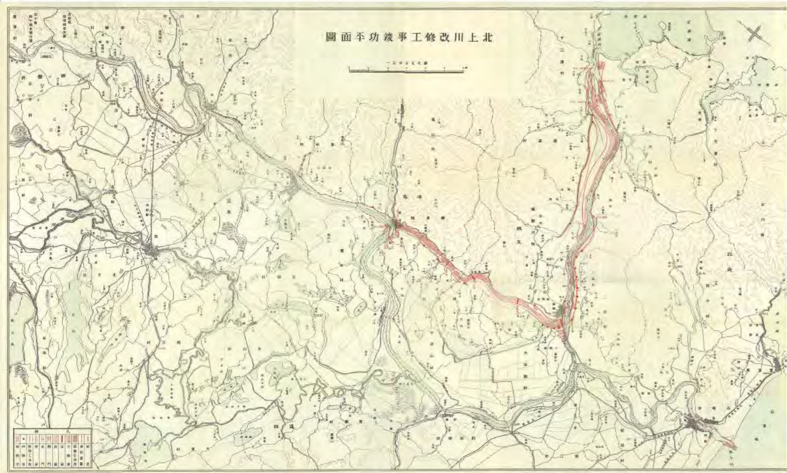
北上川第一期改修工事竣工平面図(明治44年~昭和9年:新北上川開削・分流施設建設) ※1
