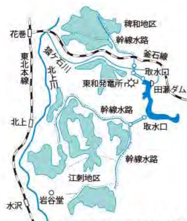
猿ヶ石川河川総合開発事業 (河水統制・発電・農業水利事業)
