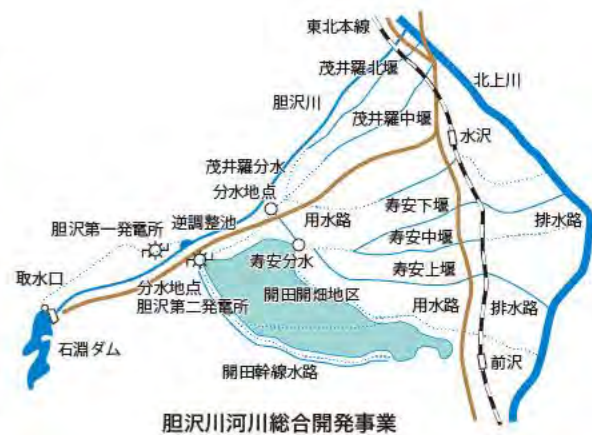
胆沢川河川総合開発事業 (河水統制・発電・農業水利事業)
