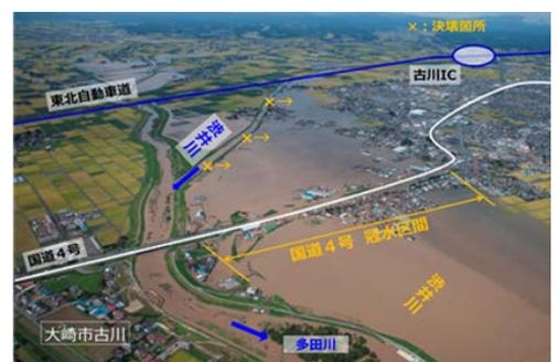
▲渋井川の堤防決壊による浸水状況(大崎市)
